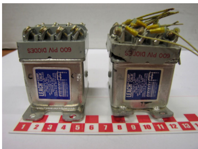
Figura 8. Comparación entre el relé recuperado y uno nuevo del mismo modelo
